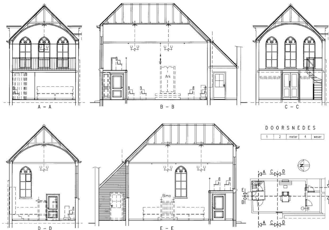
(10) Reconstructietekening met doorsneden van de synagoge uit de stichtingsfase. Op het plattegrondje rechtsonder zijn de verschillende posities van de doorsneden aangegeven. Door de plaatsing van vensters in drie gevels had de gebedsruimte een gevarieerde lichtinval. (Tek.G.J.Weaver)
