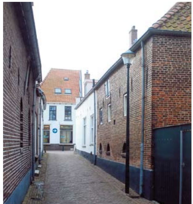
Aan de Eerste Walsteeg flankeren nog twee voormalige stadsboerderijen van formaat. In de rechter stadsboerderij Achterstraat 30 zaten ten tijde van de potstal, ter plaatse van de onderste stalraampjes, voorheen mestdeurtjes. De vensters daarboven net onder de balklaag zorgden voor daglicht op de veestalling, daarboven op de zolder een hooiluik. Tot 1978 stonden hier nog 10 stuks vee op stal.
